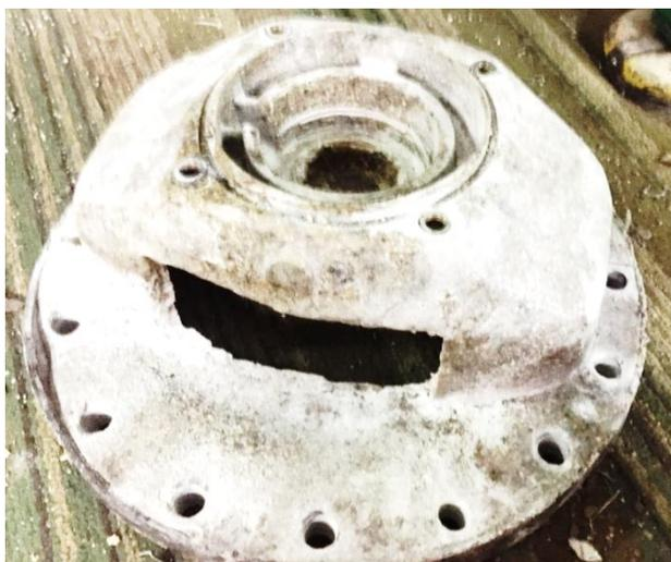
Рисунок 3 – Промежуточный фонарь центробежного насоса
