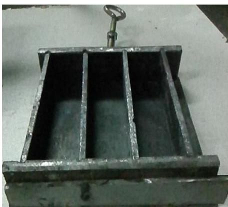
Рисунок 8 – Формы для изготовления контрольных образцов – призм квадратного сечения
