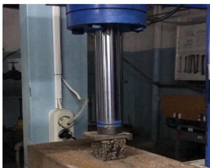
Рисунок 4 – Размещение нажимных пластинок и образцов на прессе
