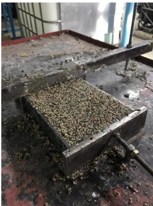
Рисунок 14 – Виброуплотнение полимербетонных пробников
