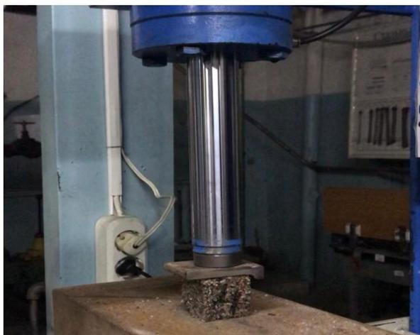
Рисунок 20 – Размещение нажимных пластинок и образцов на прессе
